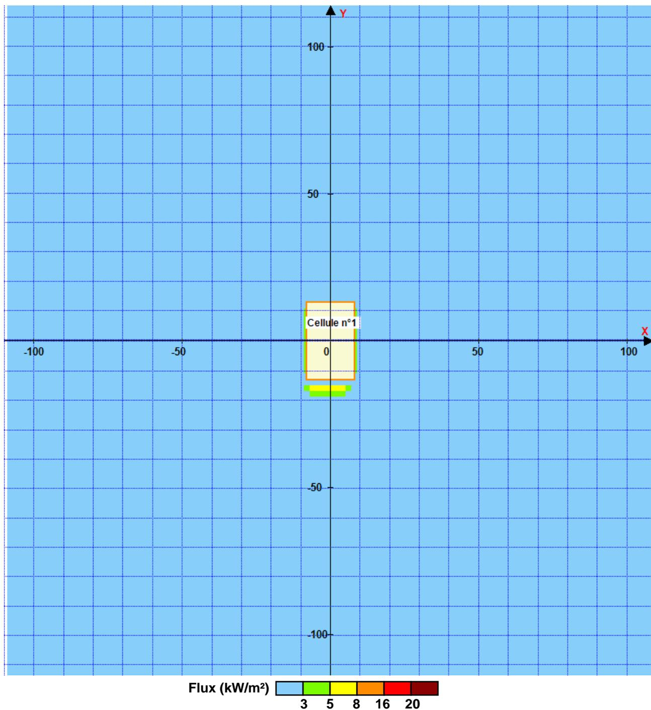
Pour information : Dans l'environnement proche de la flamme, le transfert convectif de chaleur ne peut être négligé. Il est donc préconisé pour de faibles distances d'effets comprises entre 1 et 5 m de retenir une distance d'effets de 5 m et pour celles comprises entre 6 m et 10 m de retenir 10 m.
