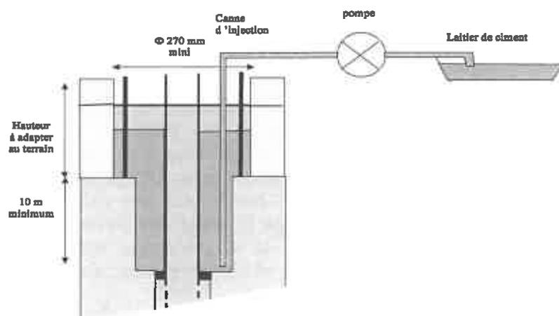
Le tubage doit avoir une résistance suffisante pour ne pas être déformé.
