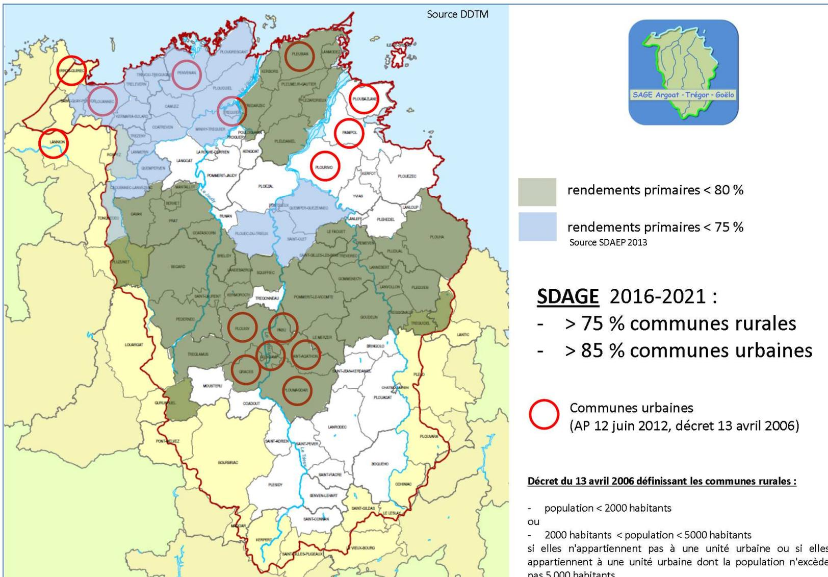
Figure 22 : Rendement des réseaux d'alimentation en eau potable sur le territoire du SAGE
