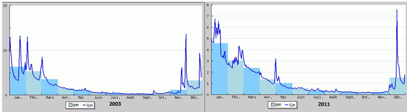
**Figure 12 : Débits journaliers moyens (Qjm) et écoulement mensuel mesuré (QMM) en m<sup>3</sup>/s en 2003 et 2011 sur la station du Leff à Quemper- Guézennec (source : banque hydro)**
