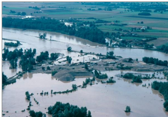
Crue de la Loire de septembre 1980 - Rupture d'une digue à Moriaud - Saint-Laurent-la-Conche (source : loire.gouv.fr)
