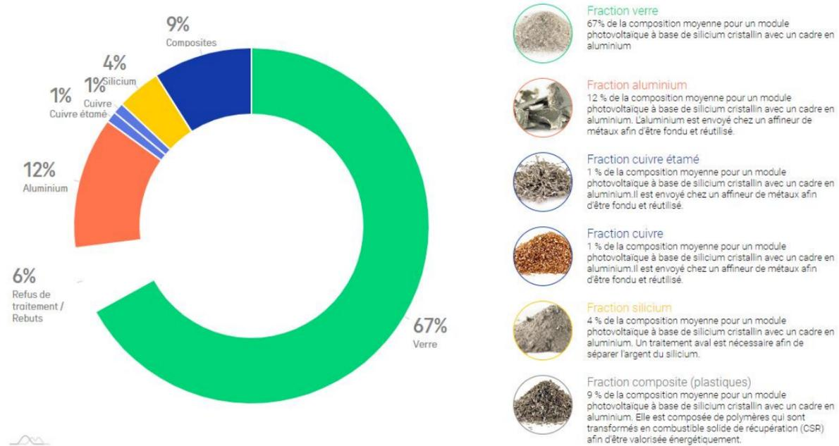
Figure 69 : Répartition des différentes fractions composant un panneau photovoltaïque. Source : <https://www.soren.eco/re-traitement-panneaux-solaires-photovoltaiques/>
